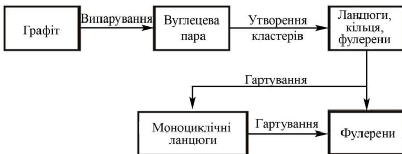
Рис. 4.11. Схема отримання фулеренів із графіту [19]
